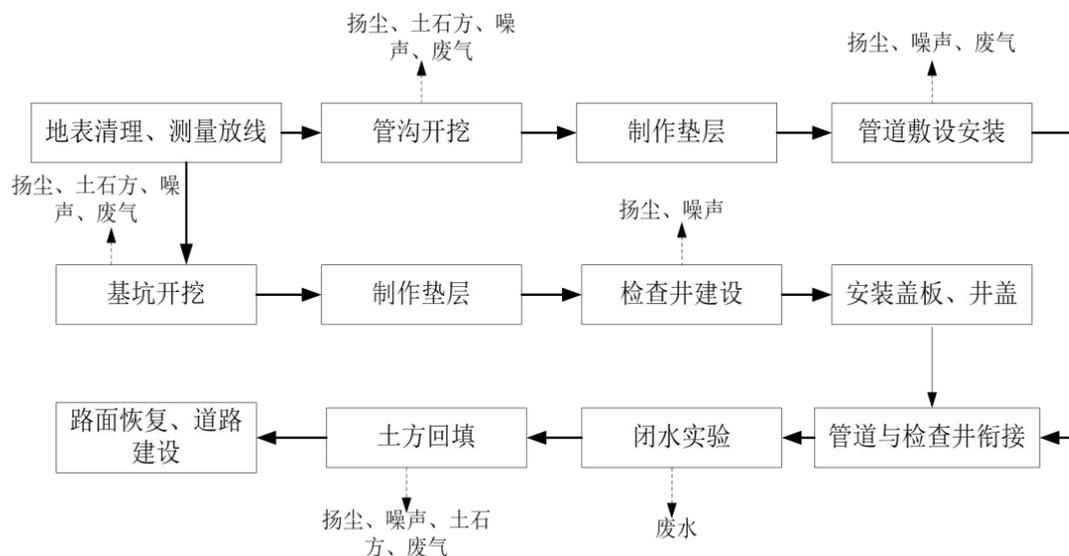
图 5-2 管网施工流程示意图
