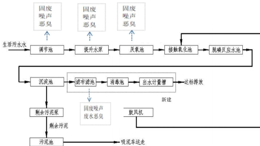
图 5-3 运营期工艺流程及产污节点图
