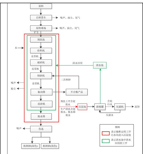
图 2-2 生产工艺流程及产污节点图
