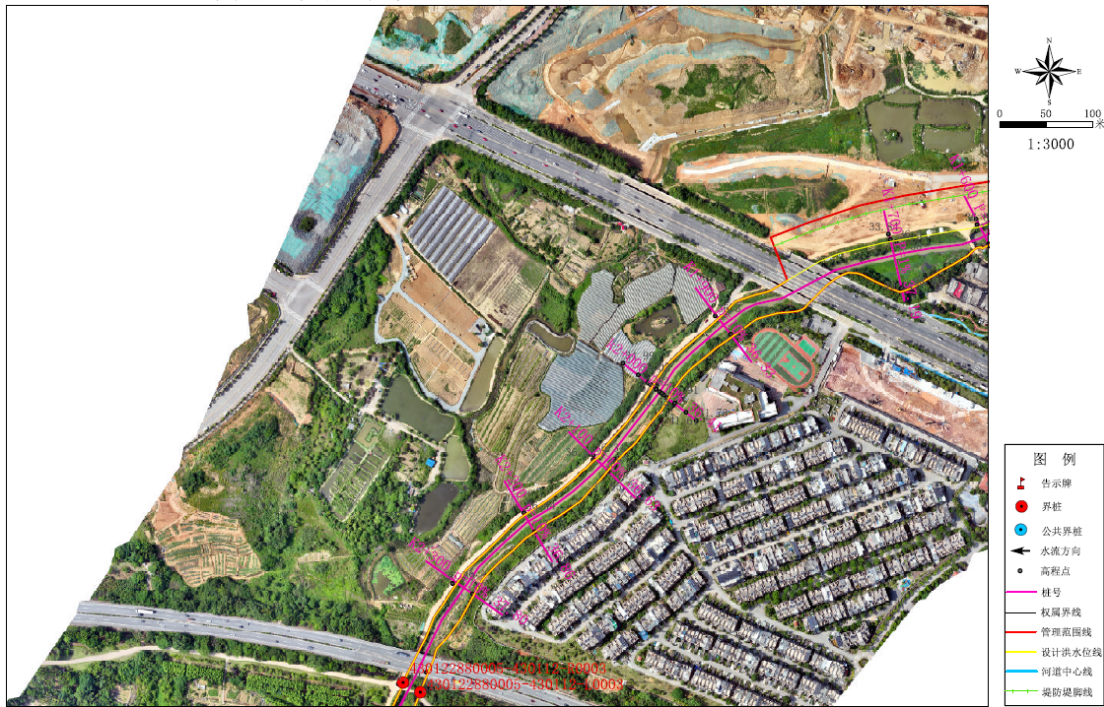
图 5.3.1 无堤防河段管理范围划定标准影像图
