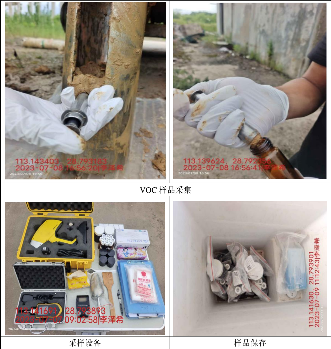
图 5-3 土壤样品采集过程照片
